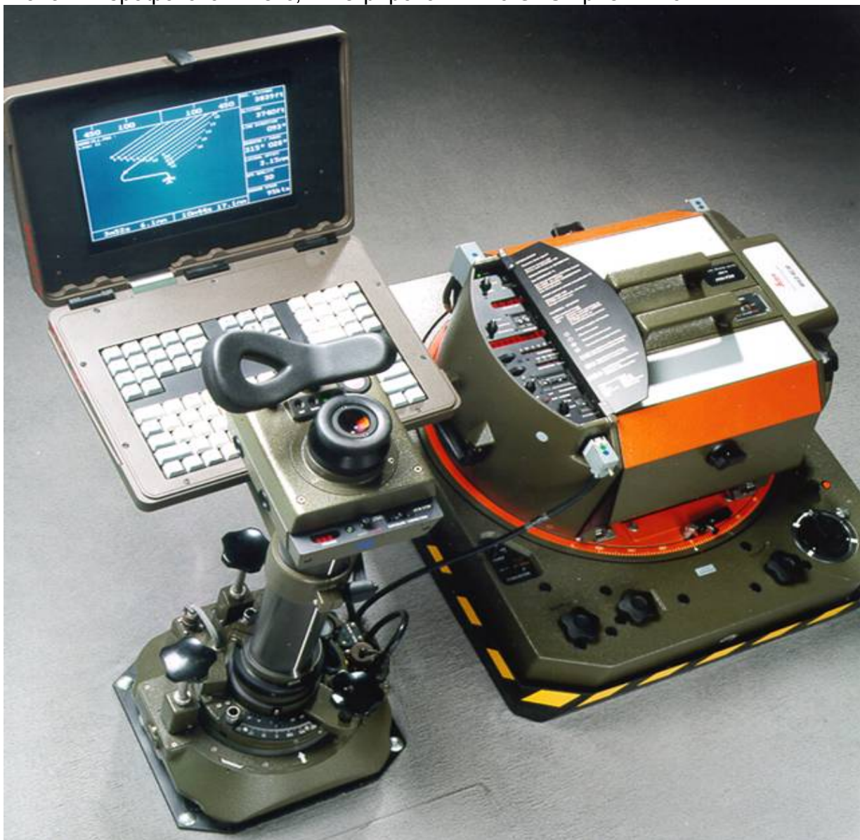
Фото 2. Аэрофотокомплекс, интегрированный с GPS-приемником
